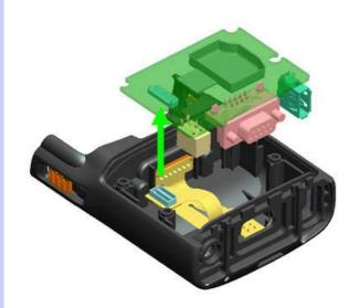
Ponga los conectores en los orificios de la carcasa delantera, como se muestra en Figura 9-14:
