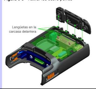
Retire los conectores de los orificios de la carcasa delantera, desconecte el conector de panel a panel de 30 clavijas desde el flexible que va al PCB y retire el conjunto del PCB desde la carcasa delantera, como se muestra en Figura 9-6:
