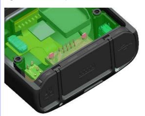
Presione verticalmente la carcasa posterior en la carcasa delantera, como se muestra en Figura 9-18:
