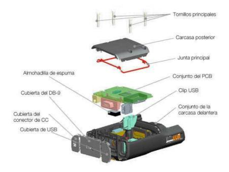
Siga el Procedimiento 9-4 para desarmar el Adaptador de seguridad.
