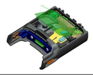
Ponga el conjunto del PCB en la carcasa delantera. Asegúrese de que el PCB se asiente correctamente en la unión de los tornillos, como se muestra en Figura 9-15:
