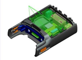
Ponga los orificios de retención del cubre polvos en las lengüetas de la carcasa delantera, como se muestra en Figura 9-16:
